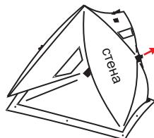
Потяните за стропу расположенную в центре одной из стен до тех пор, пока каркас стены не расправится. Для того чтобы не допустить смещения палатки наступите на ветрозащитную юбку.
