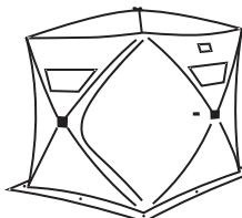
Зафиксируйте палатку на поверхности, за люверсы расположенные на углах юбки используя колышки-вертыши идущие в комплекте. Для достижения максимальной ветроустойчивости растяните палатку, используя оттяжки. Убедитесь, что оттяжки и материал палатки не перетянуты и смогут амортизировать сильный ветер. Присыпьте юбку палатки снегом. Отрегулируйте вентиляцию и освещение палатки при помощи съемных окон.
